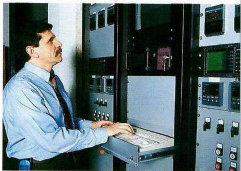
Michel Imbert montre les écrans de contrôle du four autoclave où sont cuites les pièces composites.
